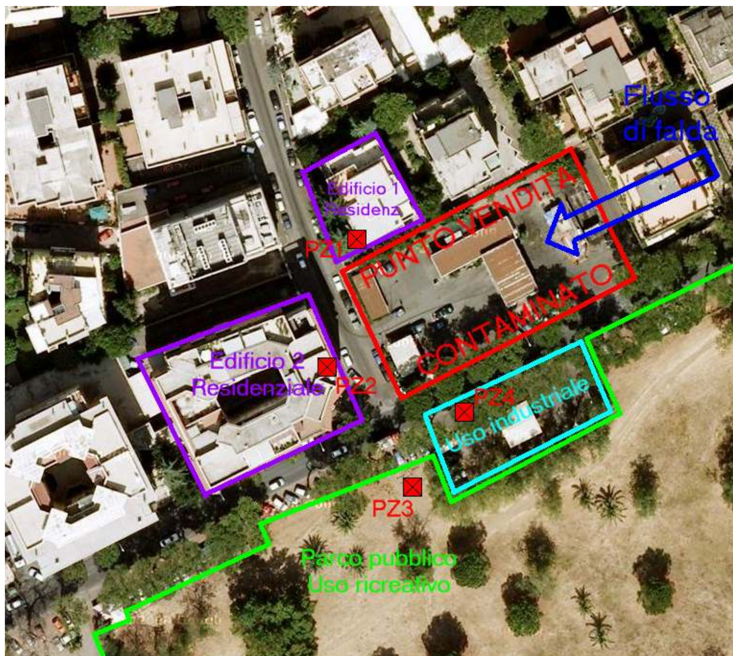
Figura V. 4.1-5 Piezometri per la delimitazione del pennacchio e l'identificazione dei recettori off-site
